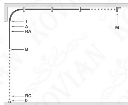
Tieto manévry sú vykonané pri nízkej rýchlosti. Ak sa vráta nachádzajú v polohe zatvorenia, je potrebné dať ich ručne do polohy približne 50 cm nad podlahou, a to s použitím systému núdzového manévru (viď návod na montáž pohonu), aby sa nestalo, že v prípade opačnej rotácie sa odmotajú láná z ich drážok (sekciónálne vráta) alebo že sa prevnú lamely (rolovacie vráta).
