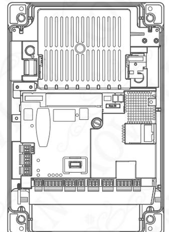
**⚠ POZOR! - Po vykonaní zapojenia bezpečnostného zariadenia je potrebné vykonať fázu 'Načítania bezpečnostných zariadení' (odsek 4.3).**
